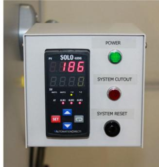
型号 FTBLL27 和 FTBLL47使用一个PID温度控制器，该控制器有四个控制区域，以改善热效果。如果温度超过610°C或供气压力降至60 PSI以下，独立的超温保护将禁用加热。流化空气由系统自动控制。
